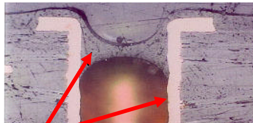
offenes Cu in Hülse, Lackreste in Bohrung
